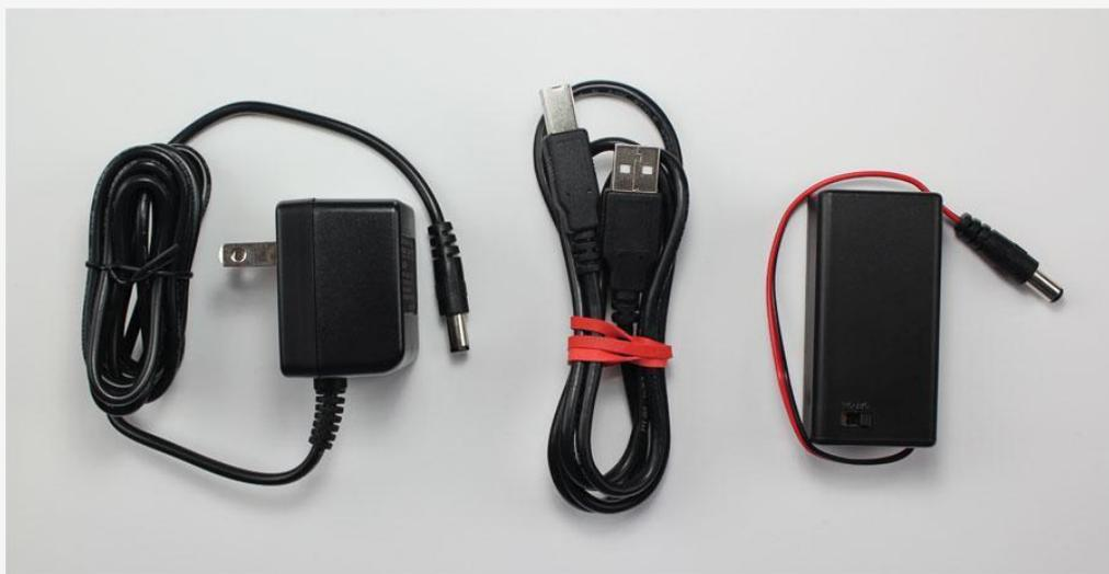
**Image 20** – Sources d'alimentation de Arduino.
