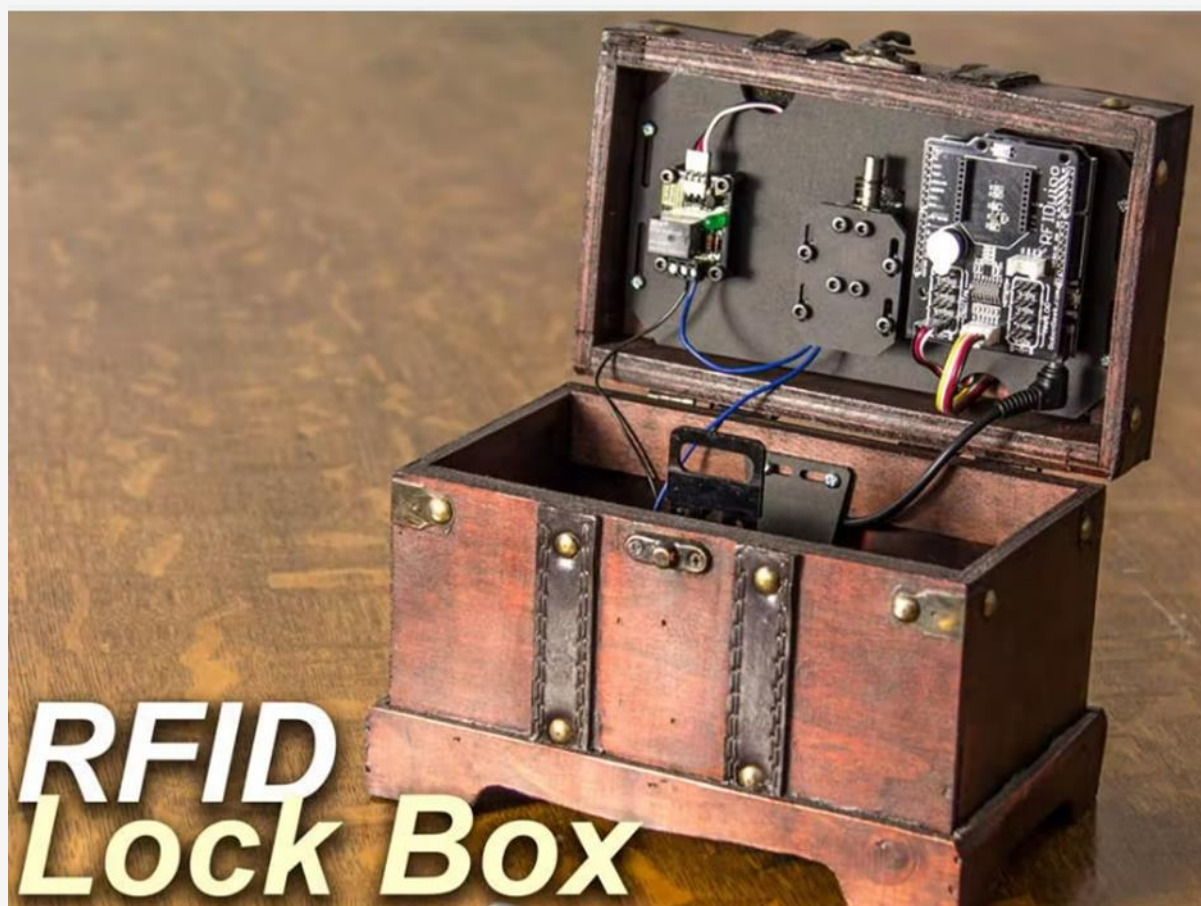
Εικόνα 27. Κουτί με κλειδαριά ελεγχόμενη από Arduino με σωληνοειδές και RFID.
