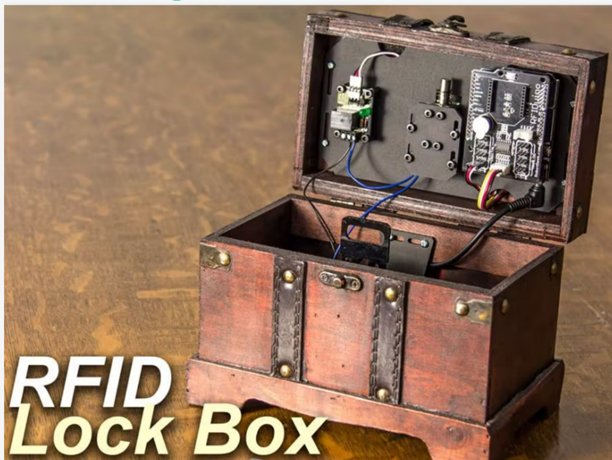
Image 27. Boîte de verrouillage contrôlée par Arduino avec solénoïde et RFID.
